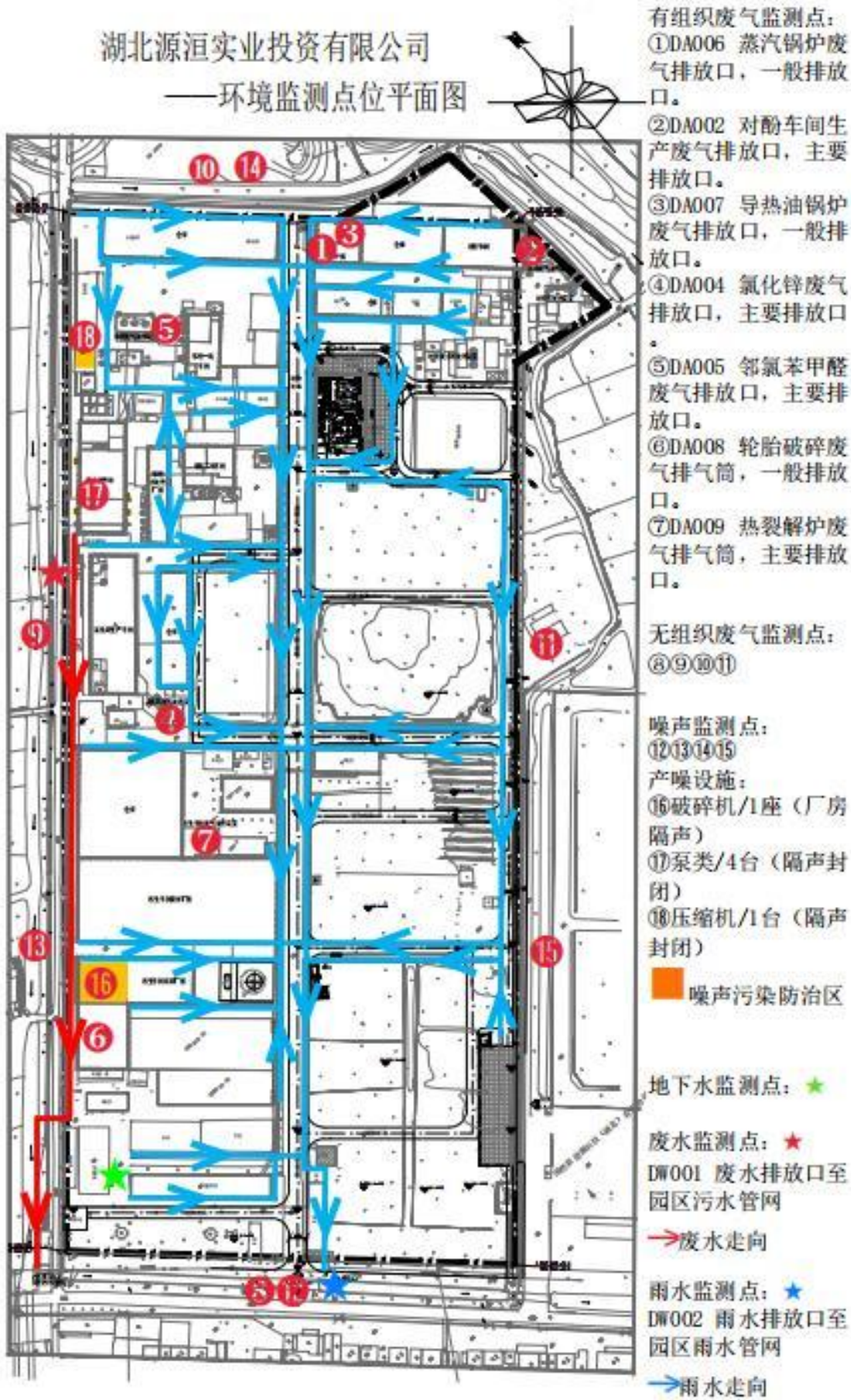
附图 3. 厂区污水管网图
