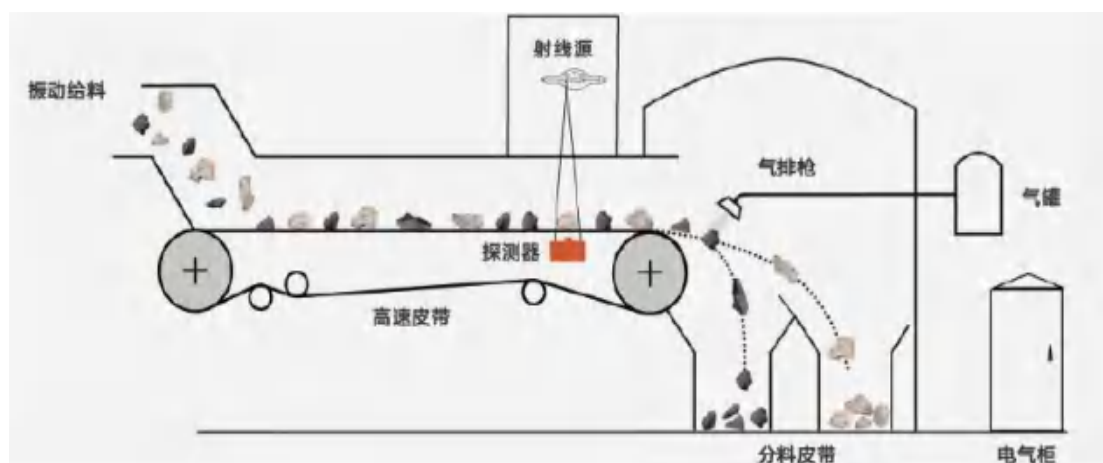
图 3.3-1 设备组成结构及分选技术原理示意图
